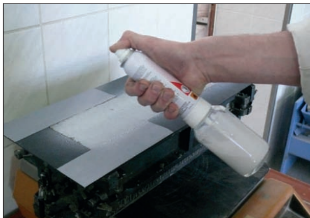
Bild 81: Beginn der Applikation von Rugasol ST mit geeignetem Sprühsystem
