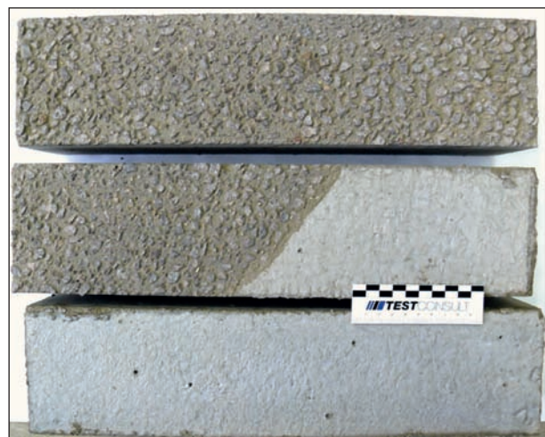
Bild 83: Probekörper (Balken 100 x 100 x 400 mm 3 ) mit Waschbetonoberfläche in verschiedenen Stadien der Oberflächenbehandlung
