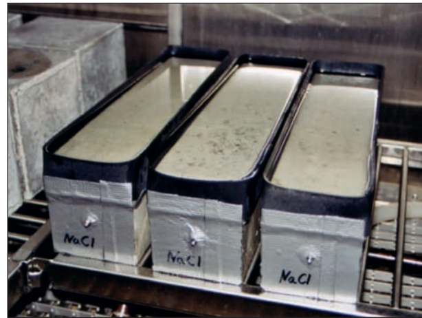
Bild 89: Betonbalken mit Taumittellösung
