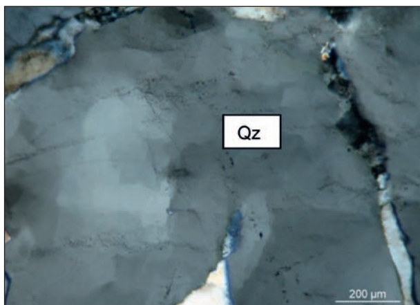
Bild 50: Granodiorit-Splitt I, Quarzkorn (Qz) mit undulöser Auslöschung, + Pol.
