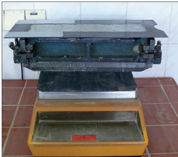
Bild 80: Form mit verdichtetem Frischbeton auf der Waage mit aufgelegter Schablone
