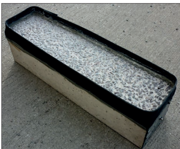
Bild 86: Probekörper (Balken 100 x 100 x 400 mm 3 ) mit Waschbetonoberfläche, präpariert für die Beaufschlagung der Probekörper mit Wasser bzw. mit Taumittel-Lösung
