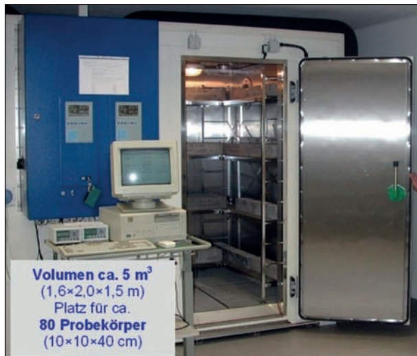
Bild 88: FIB-Klimasimulationskammer (Fa. Feutron)
