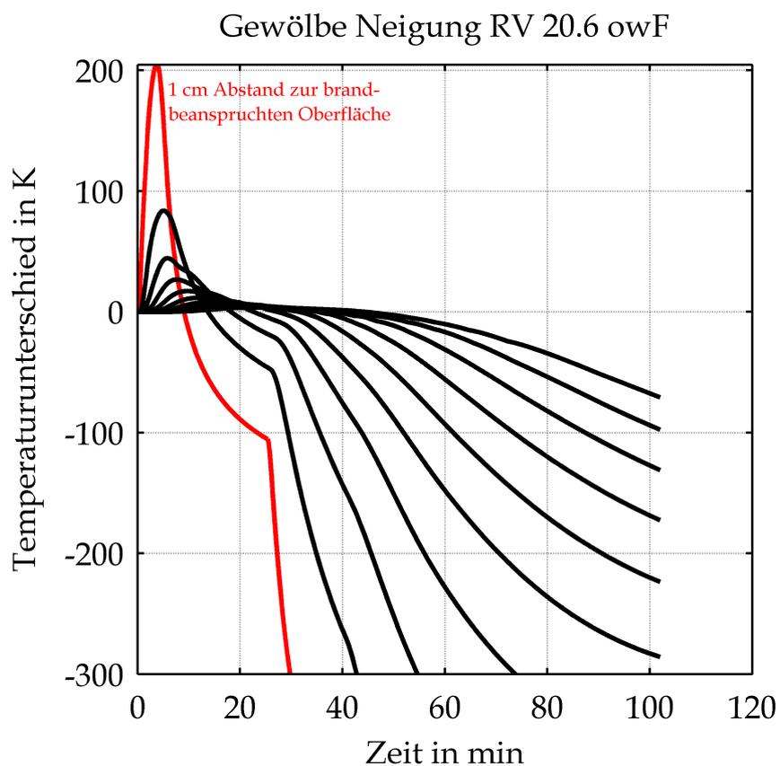
Temperaturdifferenz in Abhängigkeit von der Zeit und dem Abstand zur Bauteiloberfläche zwischen den Bauteiltemperaturen infolge des bewerteten Temperatur-Zeit-Verlauf und der verlängerten ZTV-ING-Temperatur-Zeit-Kurve
