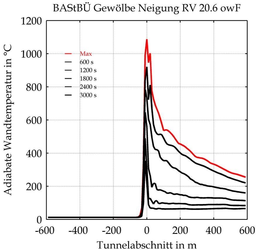
Mittels CFD-Berechnung ermittelte adiabate Wandtemperaturen in 3 m Höhe in Abhängigkeit von der Zeit unter Berücksichtigung der Ventilationsbedingungen bzw. der Sauerstoffversorgung (rot: Maximalwerte, schwarz: Temperaturen in Abhängigkeit von der Einwirkungsdauer)
