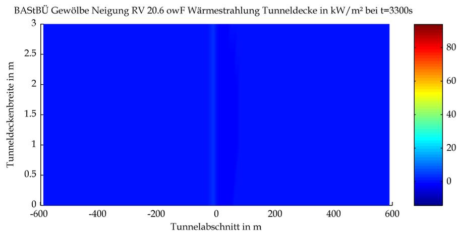
Mittels CFD-Berechnung ermittelte Strahlungswärme an der Tunneldecke
