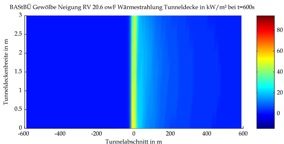
Mittels CFD-Berechnung ermittelte Strahlungswärme an der Tunneldecke
