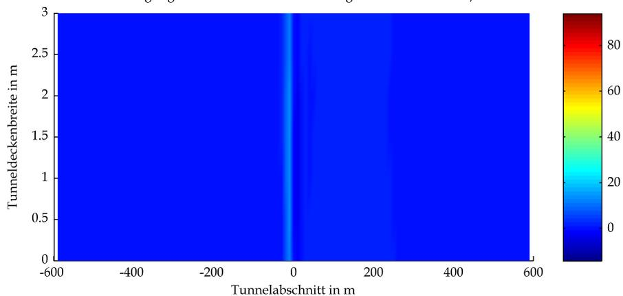
BAStBÜ Gewölbe Neigung RV 20.6 owF Wärmestrahlung Tunneldecke in kW/m<sup>2</sup> bei t=2100s
