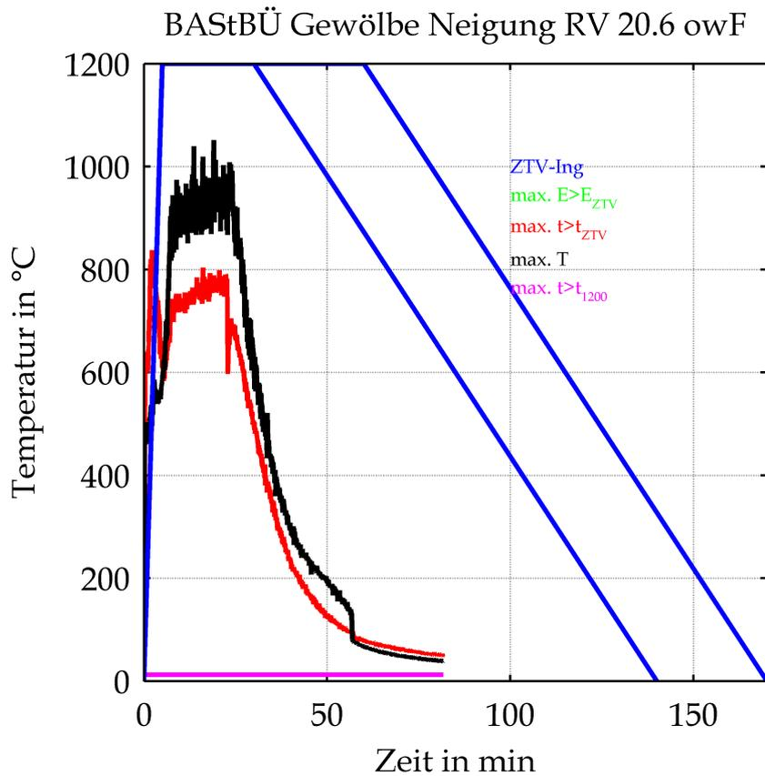
Mittels CFD-Berechnung ermittelte Temperatur-Zeit-Verläufe für die Maximalwerte der zuvor dargestellten Kriterien unter Berücksichtigung der Ventilationsbedingungen bzw. der Sauerstoffversorgung (blau: ZTV-ING-Temperatur-Zeit-Verlauf)
