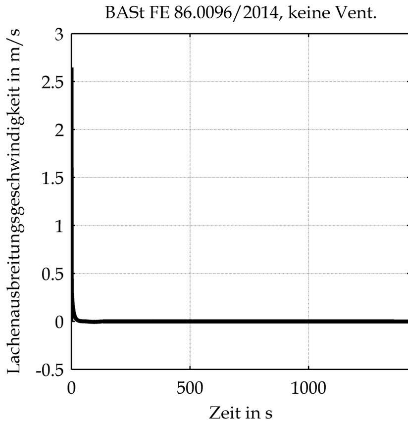
Ausbreitungsgeschwindigkeit der Lache in Abhängigkeit
