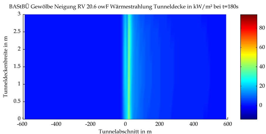
Mittels CFD-Berechnung ermittelte Strahlungswärme an der Tunneldecke
