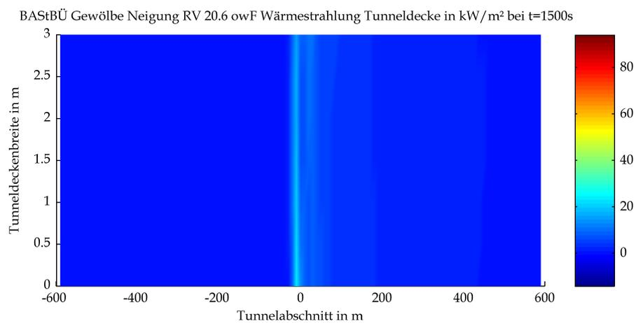
Mittels CFD-Berechnung ermittelte Strahlungswärme an der Tunneldecke
