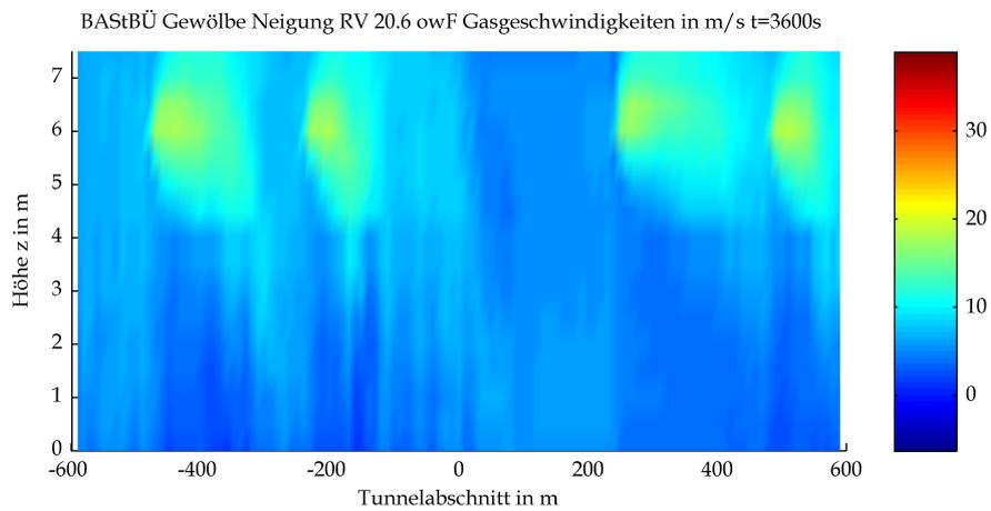
Mittels CFD-Berechnung ermittelte Gasgeschwindigkeit
