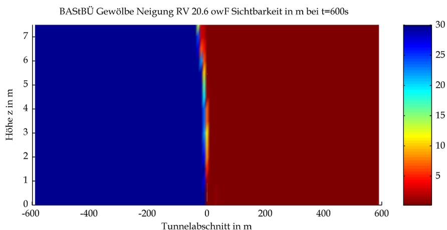
Mittels CFD-Berechnung ermittelte Sichtweiten
