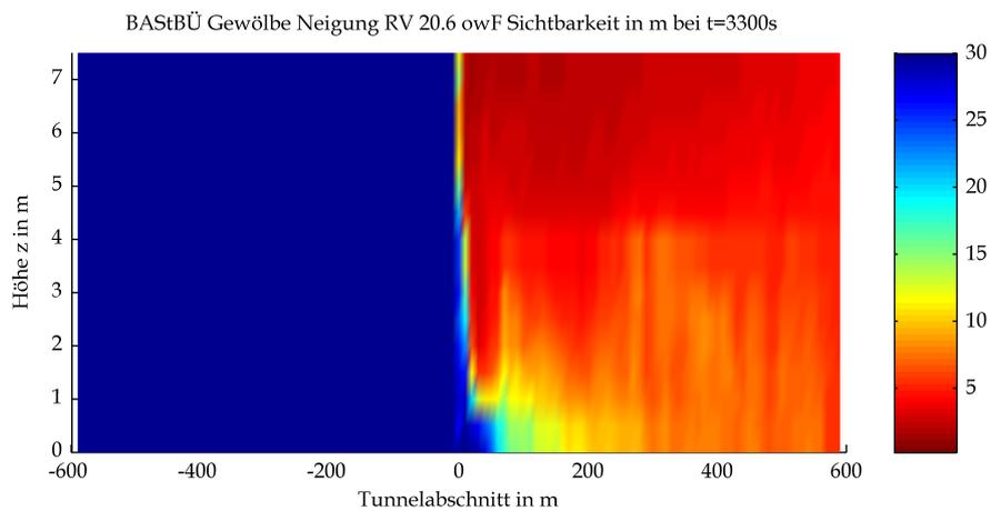
Mittels CFD-Berechnung ermittelte Sichtweiten
