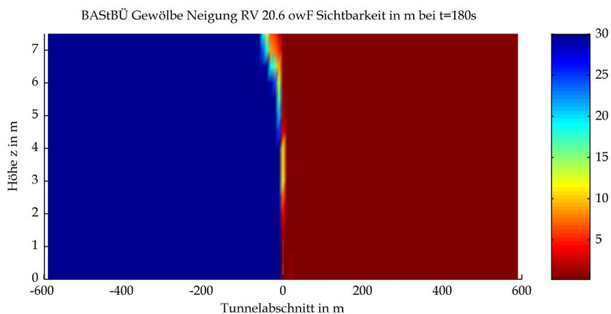
Mittels CFD-Berechnung ermittelte Sichtweiten
