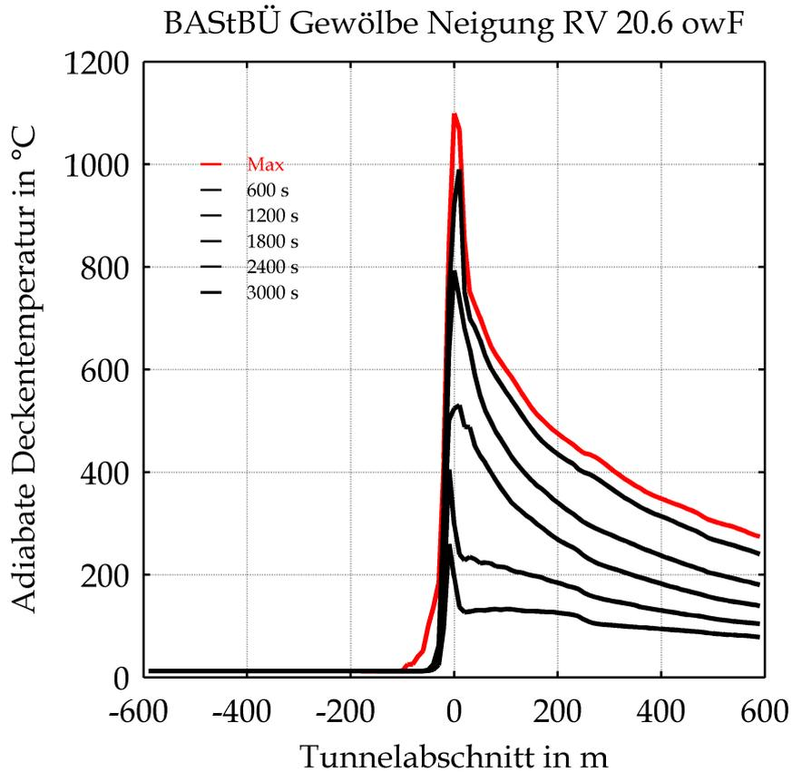
Mittels CFD-Berechnung ermittelte adiabate Deckentemperaturen in Abhängigkeit von der Zeit unter Berücksichtigung der Ventilationsbedingungen bzw. der Sauerstoffversorgung (rot: Maximalwerte, schwarz: Temperaturen in Abhängigkeit von der Einwirkungsdauer)
