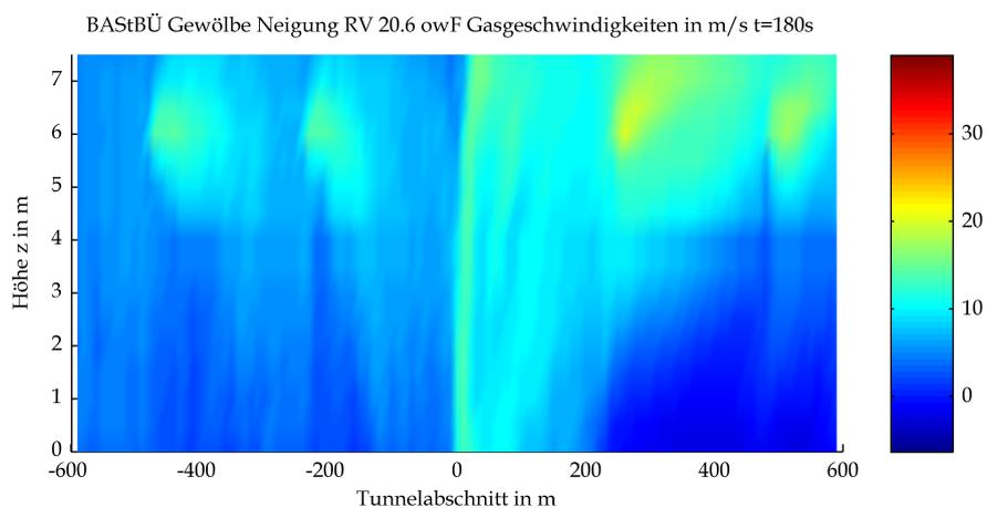
Mittels CFD-Berechnung ermittelte Gasgeschwindigkeit
