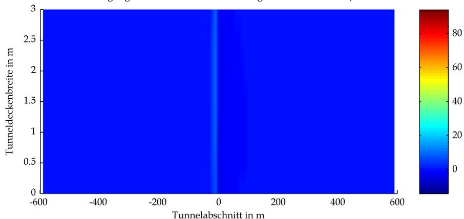
Mittels CFD-Berechnung ermittelte Strahlungswärme an der Tunneldecke
