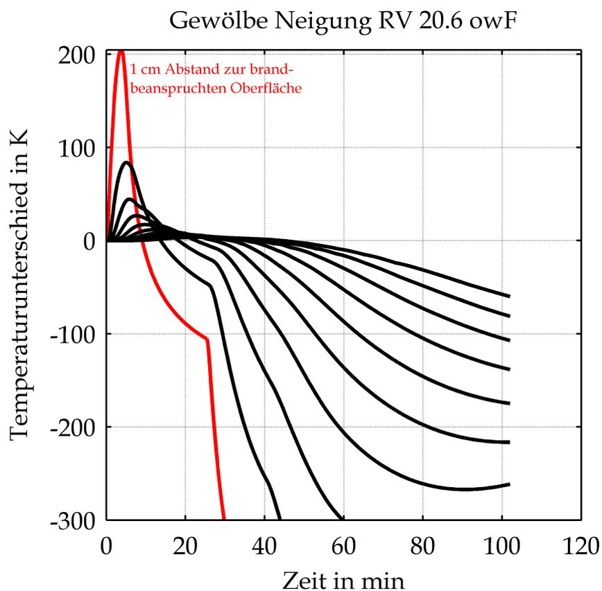
Temperaturdifferenz in Abhängigkeit von der Zeit und dem Abstand zur Bauteiloberfläche zwischen den Bauteiltemperaturen infolge des bewerteten Temperatur-Zeit-Verlauf und der ZTV-ING-Temperatur-Zeit-Kurve
