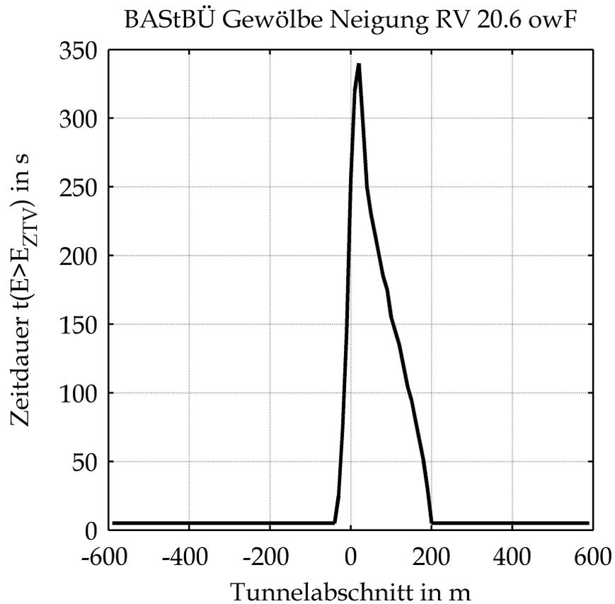
Mittels CFD-Berechnung ermittelte Zeitdauer mit im Vergleich zur ZTV-ING-Kurve höheren Energieeinträgen in die Tunneldecke in Abhängigkeit von der Tunnellänge unter Berücksichtigung der Ventilationsbedingungen bzw. der Sauerstoffversorgung
