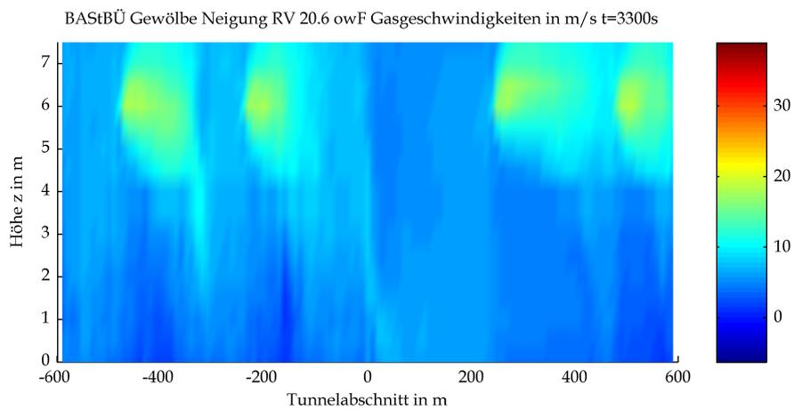
Mittels CFD-Berechnung ermittelte Gasgeschwindigkeit
