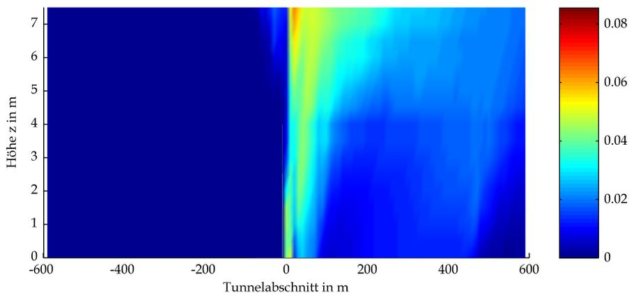
BAStBÜ Gewölbe Neigung RV 20.6 owF CO<sub>2</sub>-Gehalt in Masse-% bei t=180s
