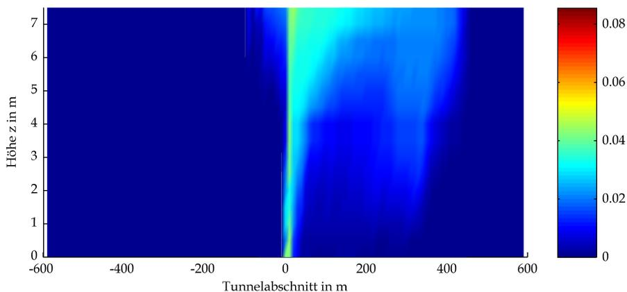
BAStBÜ Gewölbe Neigung RV 20.6 owF CO<sub>2</sub>-Gehalt in Masse-% bei t=120s
