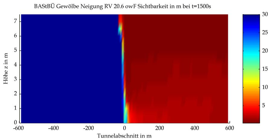
Mittels CFD-Berechnung ermittelte Sichtweiten
