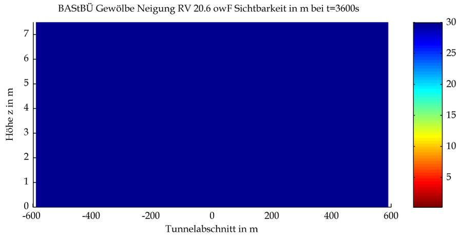
Mittels CFD-Berechnung ermittelte Sichtweiten
