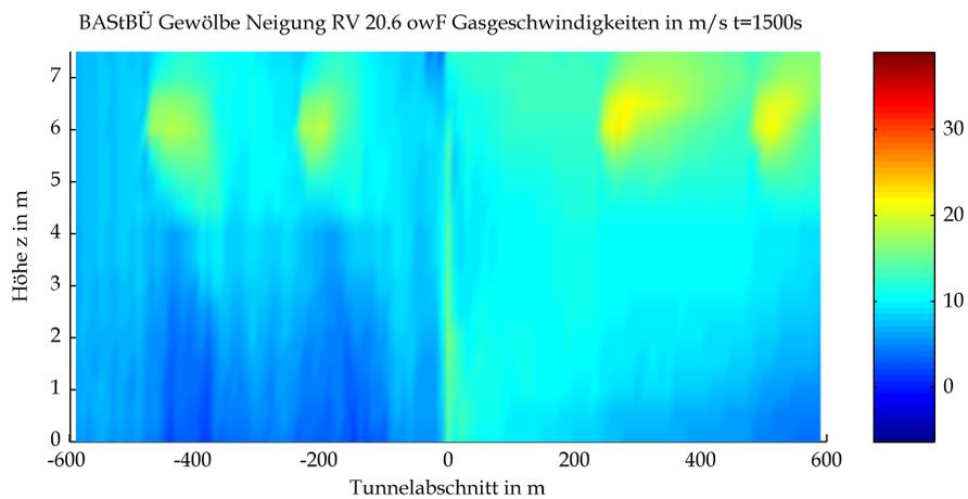
Mittels CFD-Berechnung ermittelte Gasgeschwindigkeit
