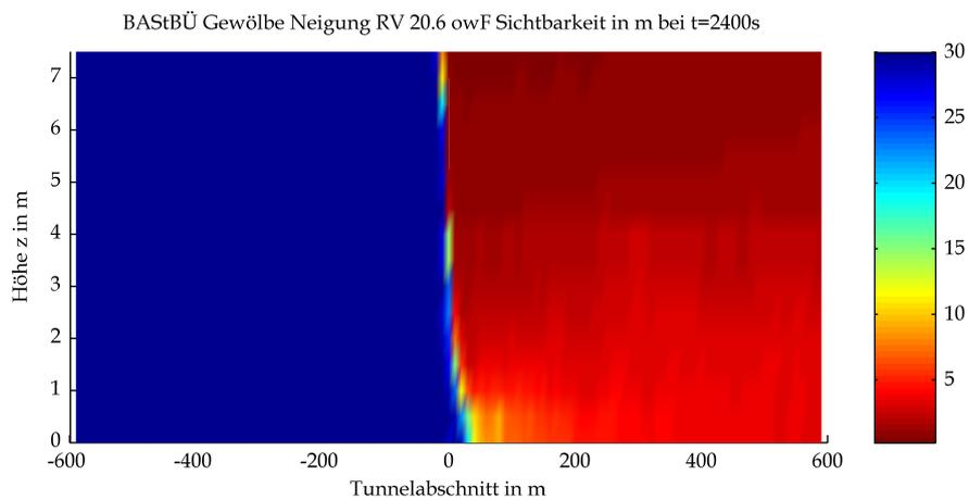
Mittels CFD-Berechnung ermittelte Sichtweiten
