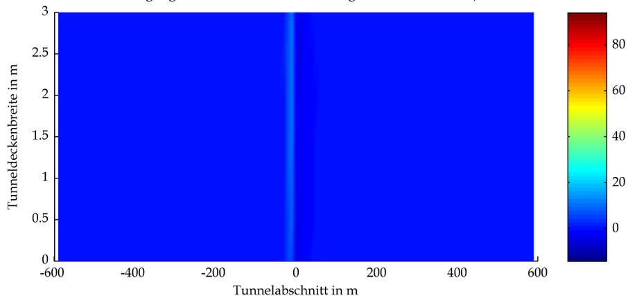
BAStBÜ Gewölbe Neigung RV 20.6 owF Wärmestrahlung Tunneldecke in kW/m<sup>2</sup> bei t=2400s
