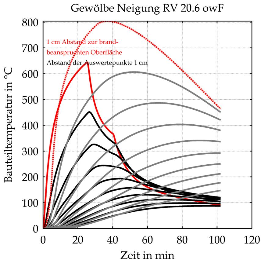
Bauteiltemperaturen in Abhängigkeit von der Zeit und dem Abstand zur Bauteiloberfläche für den bewerteten Temperatur-Zeit-Verlauf (rot und schwarz) und infolge ZTV-ING-Temperatur-Zeit-Kurve (rot gestrichelt, grau)
