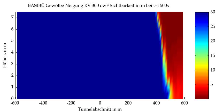
Mittels CFD-Berechnung ermittelte Sichtweiten
