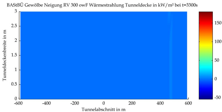
Mittels CFD-Berechnung ermittelte Strahlungswärme an der Tunneldecke
