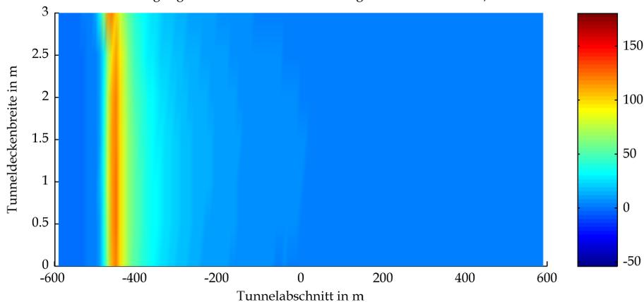
Mittels CFD-Berechnung ermittelte Strahlungswärme an der Tunneldecke
