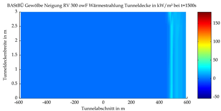
Mittels CFD-Berechnung ermittelte Strahlungswärme an der Tunneldecke
