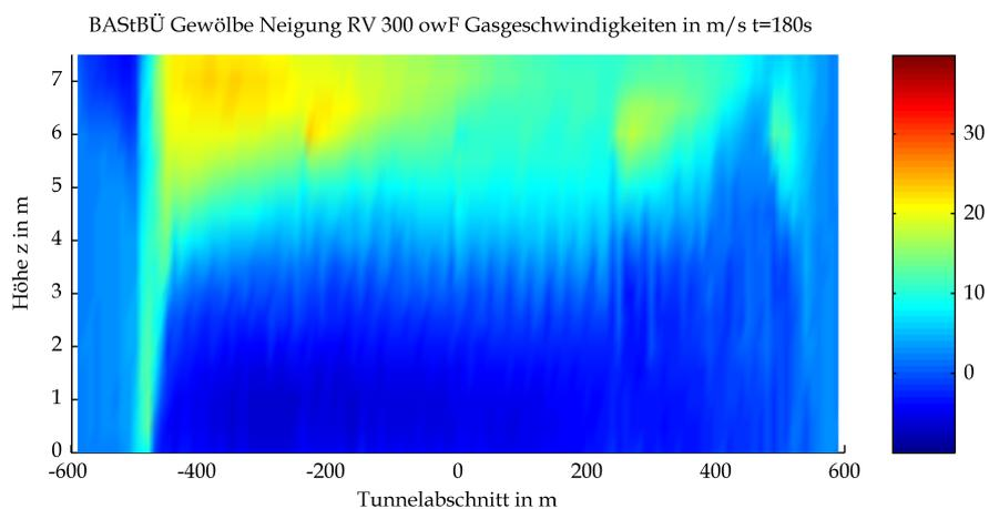
Mittels CFD-Berechnung ermittelte Gasgeschwindigkeit
