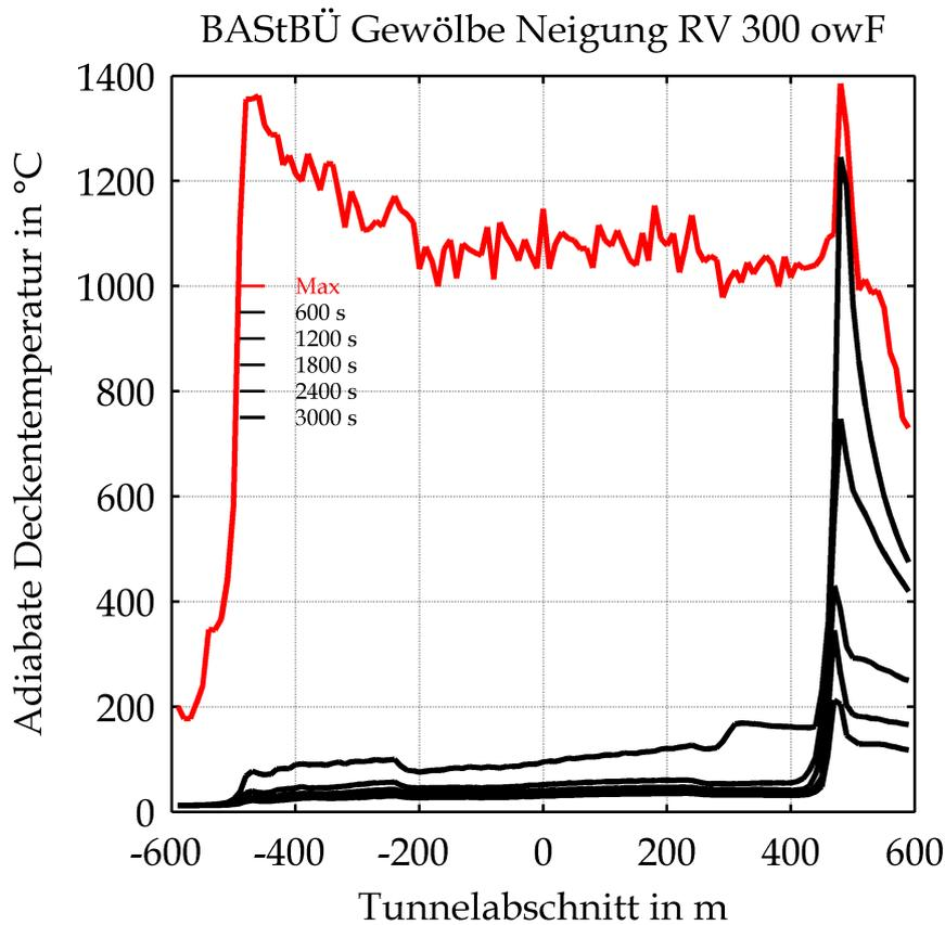
Mittels CFD-Berechnung ermittelte adiabate Deckentemperaturen in Abhängigkeit von der Zeit unter Berücksichtigung der Ventilationsbedingungen bzw. der Sauerstoffversorgung (rot: Maximalwerte, schwarz: Temperaturen in Abhängigkeit von der Einwirkungsdauer)
