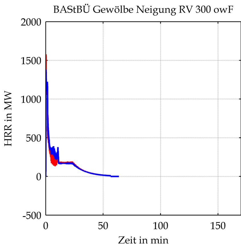
Mittels CFD-Berechnung ermittelte Wärmefreisetzungsrates in Abhängigkeit von der Zeit unter Berücksichtigung der Ventilationsbedingungen bzw. der Sauerstoffversorgung (rot: Integral der Energiedichte; blau: Energieverluste an den Modellgrenzen)
