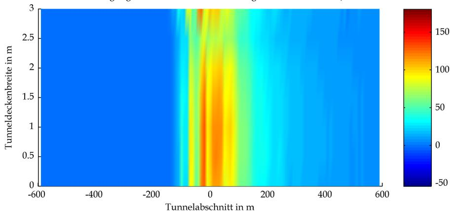
BAStBÜ Gewölbe Neigung RV 300 owF Wärmestrahlung Tunneldecke in kW/m<sup>2</sup> bei t=120s
