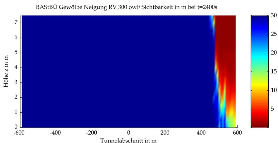
Mittels CFD-Berechnung ermittelte Sichtweiten
