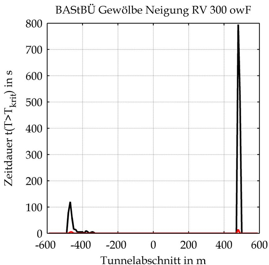
Mittels CFD-Berechnung ermittelte Zeitdauer der adiabaten Deckentemperatur größer 1200°C (schwarz) bzw. größer 1350°C (rot) in Abhängigkeit von der Tunnellänge unter Berücksichtigung der Ventilationsbedingungen bzw. der Sauerstoffversorgung
