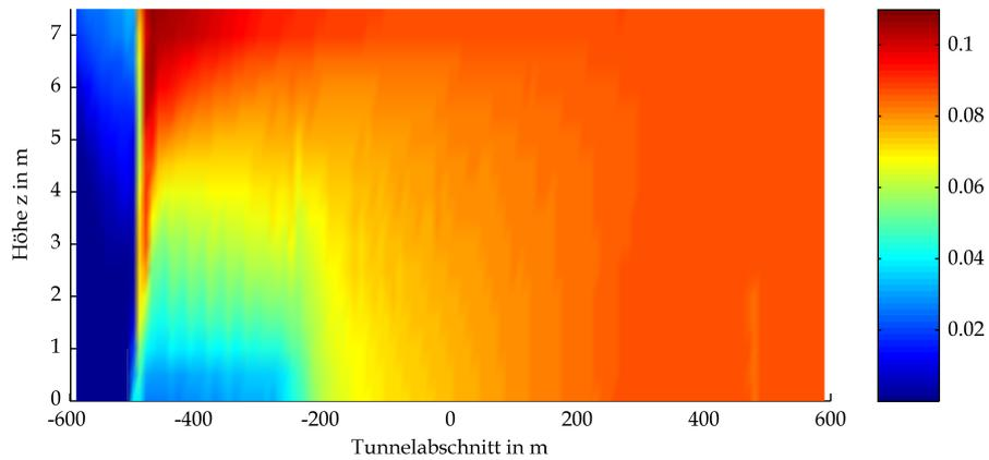
BASTBÜ Gewölbe Neigung RV 300 owF CO<sub>2</sub>-Gehalt in Masse-% bei t=300s
