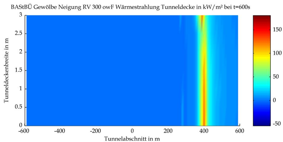
Mittels CFD-Berechnung ermittelte Strahlungswärme an der Tunneldecke
