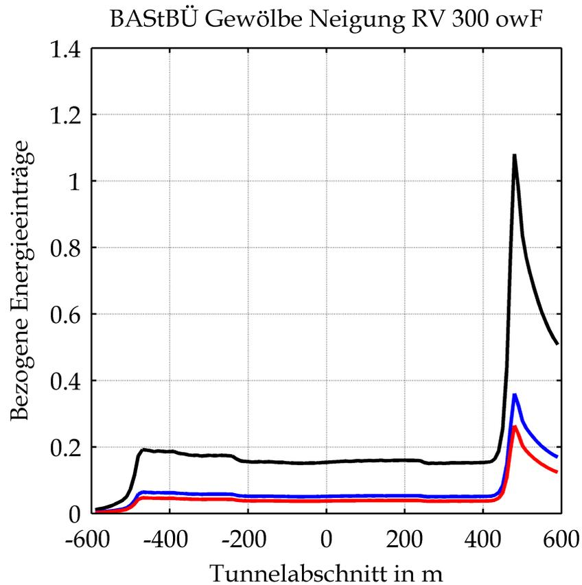
Mittels CFD-Berechnung ermittelte, auf den Energieeintrag der ZTV-ING-Temperatur-Zeit-Kurve bezogene Energieeinträge in Abhängigkeit von der Tunnellänge unter Berücksichtigung der Ventilationsbedingungen bzw. der Sauerstoffversorgung (blau: Basiswert ZTV-ING 150 min, schwarz: Basiswert ZTV-ING 30 min)
