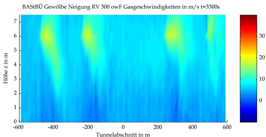
Mittels CFD-Berechnung ermittelte Gasgeschwindigkeit
