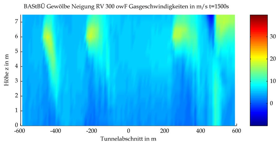
Mittels CFD-Berechnung ermittelte Gasgeschwindigkeit
