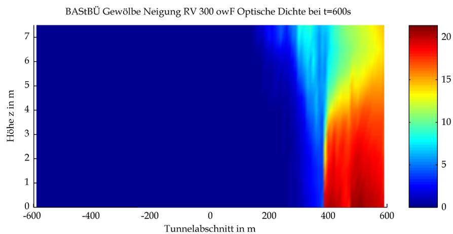
Mittels CFD-Berechnung ermittelte optische Dichten
