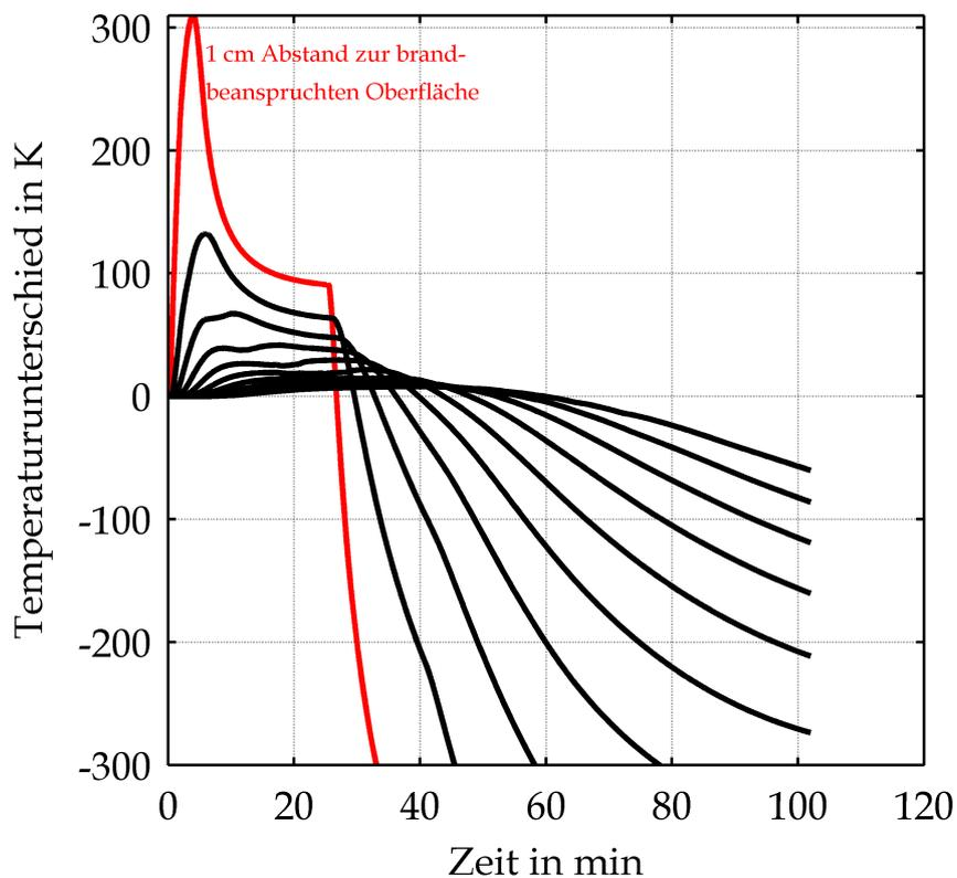
Temperaturdifferenz in Abhängigkeit von der Zeit und dem Abstand zur Bauteiloberfläche zwischen den Bauteiltemperaturen infolge des bewerteten Temperatur-Zeit-Verlauf und der verlängerten ZTV-ING-Temperatur-Zeit-Kurve
