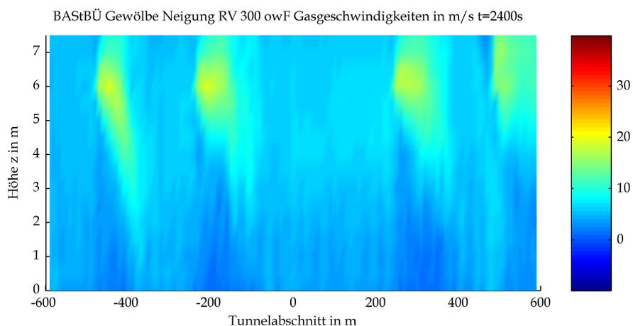
Mittels CFD-Berechnung ermittelte Gasgeschwindigkeit
