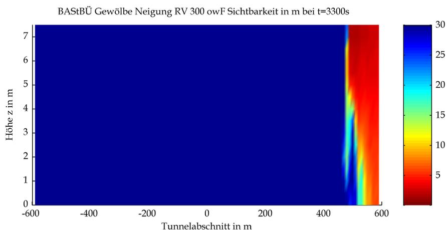
Mittels CFD-Berechnung ermittelte Sichtweiten
