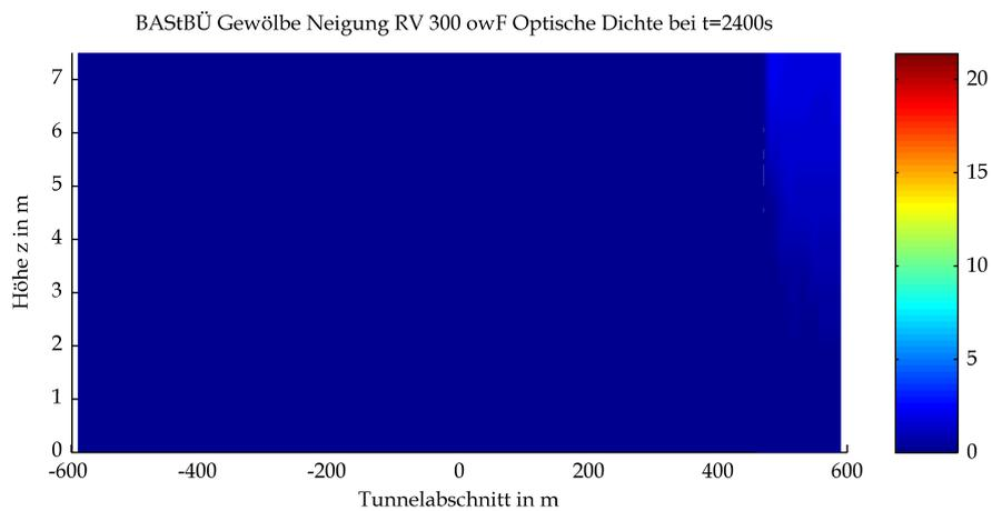
Mittels CFD-Berechnung ermittelte optische Dichten
