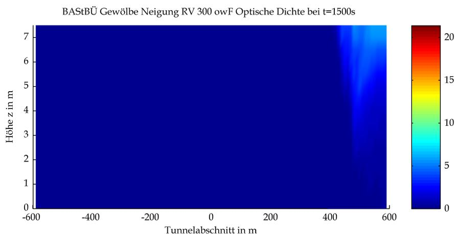
Mittels CFD-Berechnung ermittelte optische Dichten
