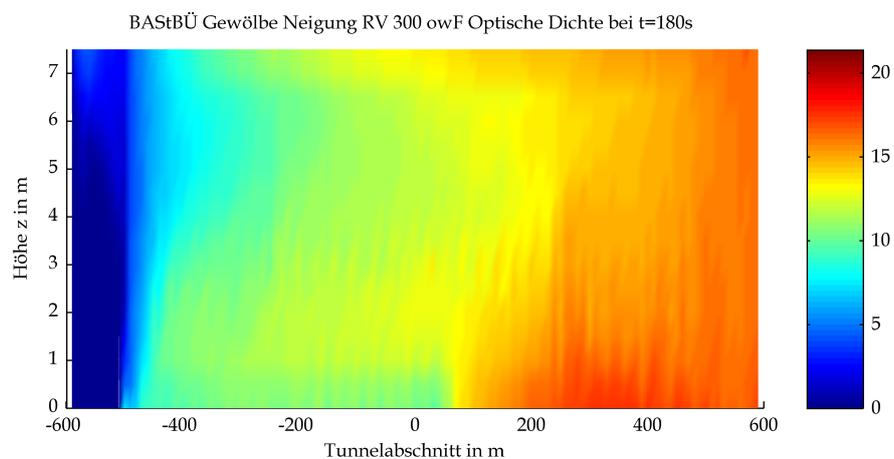
Mittels CFD-Berechnung ermittelte optische Dichten
