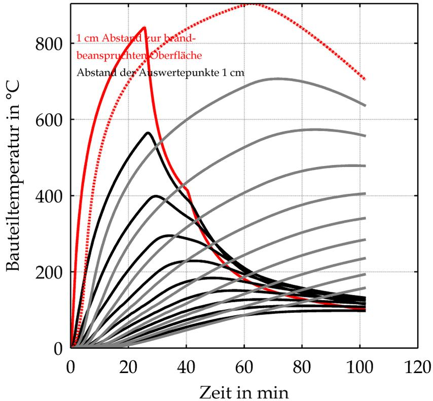
Bauteiltemperaturen in Abhängigkeit von der Zeit und dem Abstand zur Bauteiloberfläche für den bewerteten Temperatur-Zeit-Verlauf (rot und schwarz) und infolge verlängerter ZTV-ING-Temperatur-Zeit-Kurve (rot gestrichelt, grau)
