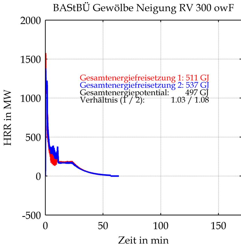
Mittels CFD-Berechnung ermittelte Wärmefreisetzungsrate in Abhängigkeit von der Zeit unter Berücksichtigung der Ventilationsbedingungen bzw. der Sauerstoffversorgung (rot: Integral der Energiedichte; blau: Energieverluste an den Modellgrenzen) sowie Vergleich der Gesamtenergiefreisetzung mit dem Gesamtenergiepotential
