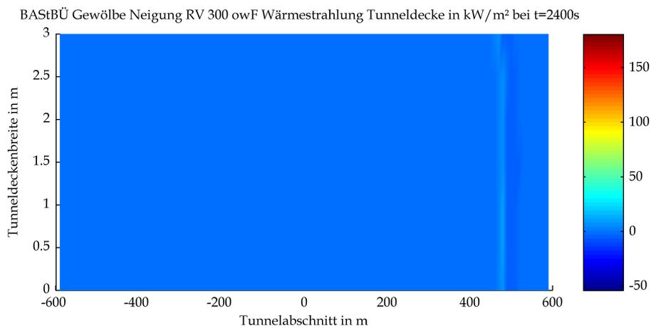
Mittels CFD-Berechnung ermittelte Strahlungswärme an der Tunneldecke
