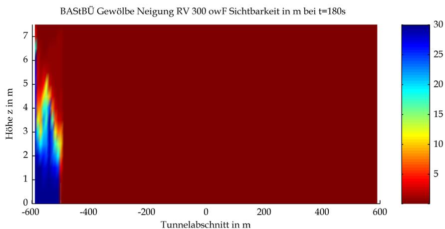
Mittels CFD-Berechnung ermittelte Sichtweiten
