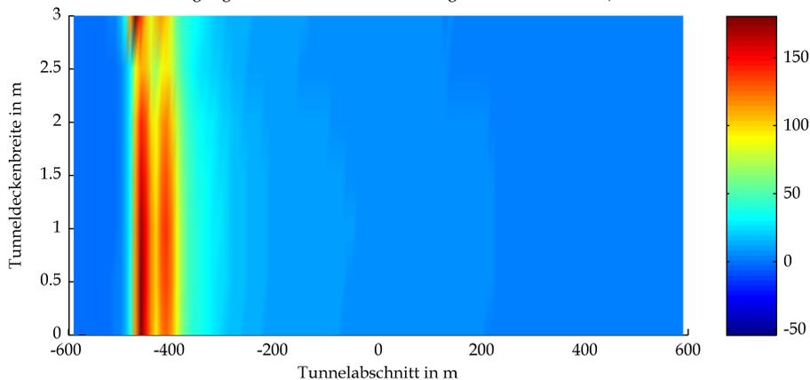
BAStBÜ Gewölbe Neigung RV 300 owF Wärmestrahlung Tunneldecke in kW/m<sup>2</sup> bei t=180s
