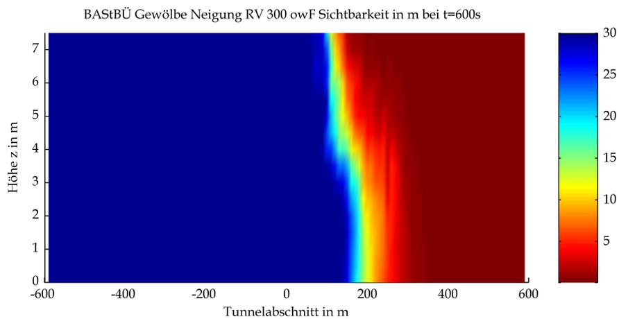
Mittels CFD-Berechnung ermittelte Sichtweiten
