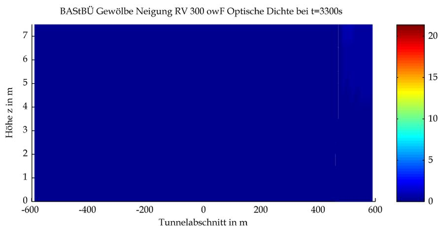
Mittels CFD-Berechnung ermittelte optische Dichten
