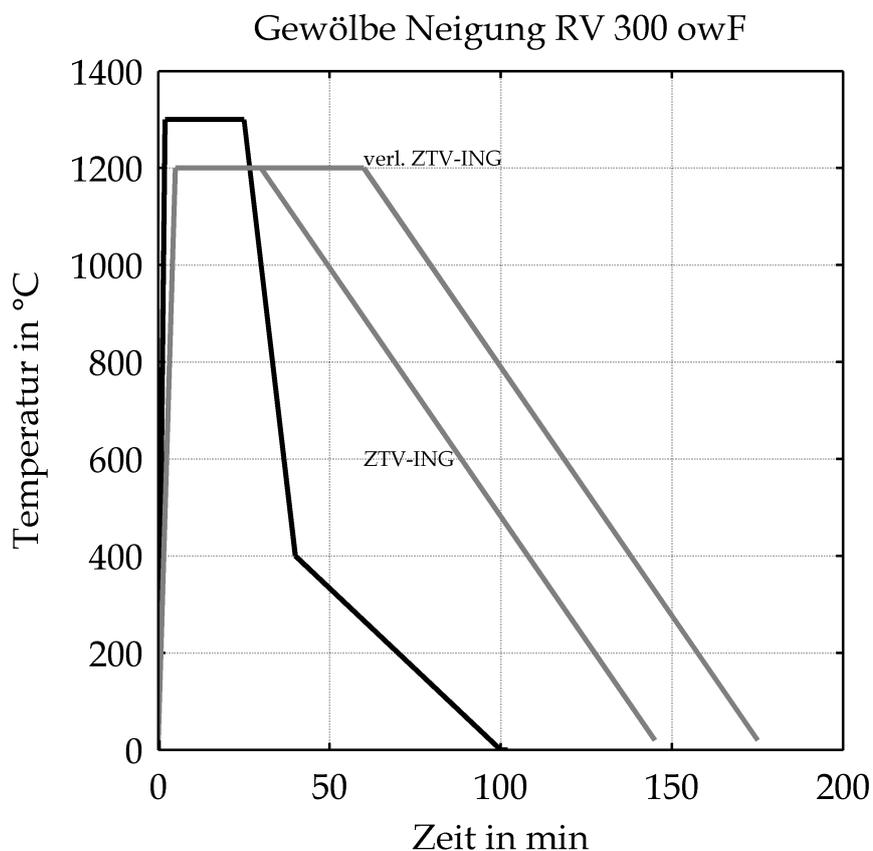
Bewerteter Temperatur-Zeit-Verlauf unter Berücksichtigung der Ventilationsbedingungen bzw. der Sauerstoffversorgung (schwarz) sowie Temperatur-Zeit-Verlauf nach ZTV-ING und RWS-Kurve (beide grau)
