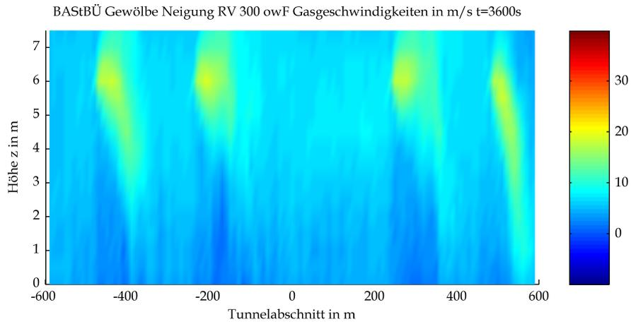
Mittels CFD-Berechnung ermittelte Gasgeschwindigkeit
