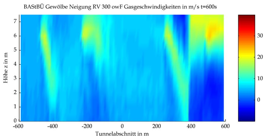
Mittels CFD-Berechnung ermittelte Gasgeschwindigkeit
