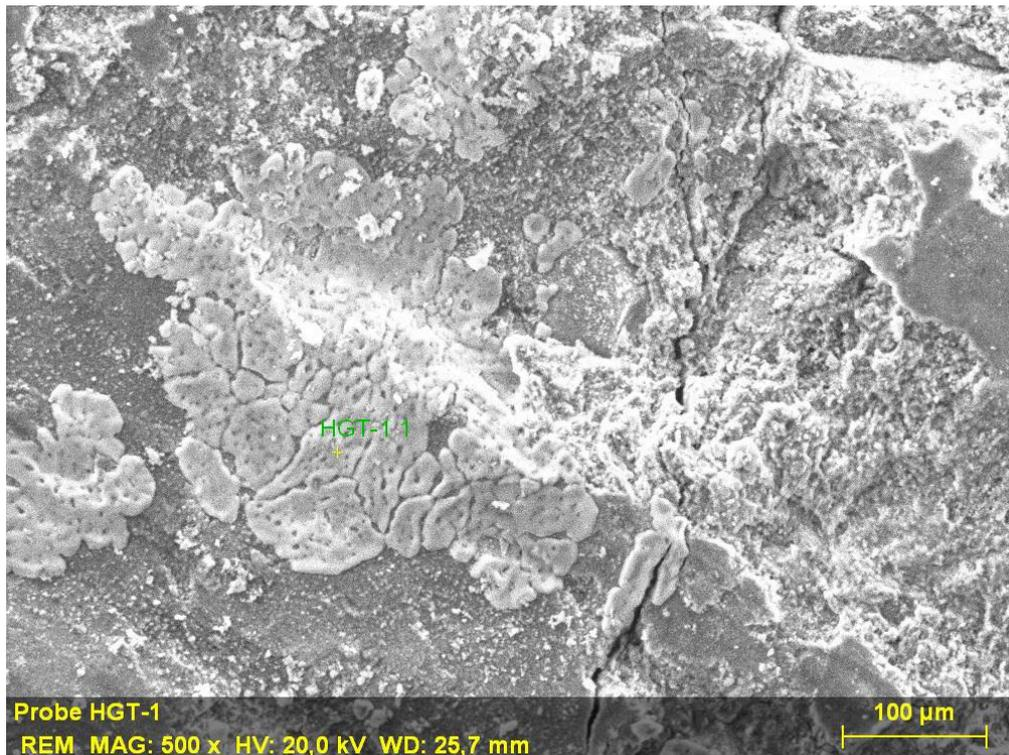
**Bild 64:** Ablagerung von nahezu reinem NaCl im Gefüge des HGT-Betons, Probe 1
