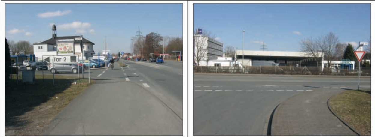
Bild 7-23: Beschilderung gemäß VwV-StVO, aber Schenkellänge des Sichtdreiecks aus Einmündung auf Radverkehr in linker Richtung nur 20 m
