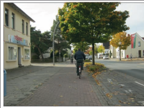
Bild 7-26: Sicherung gemäß VwV-StVO und roteingefärbte Radverkehrsfurt (Sicht auf Radverkehr in rechter Richtung eingeschränkt, Markierung im Jahr 2013 ausgebleicht)
