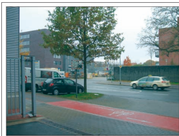
Bild 7-21: Grundstückszufahrt mit eingeschränkten Sichtfeldern und zusätzlicher Sicherung durch Sichtspiegel (Standort des Sichtspiegels für linke Radverkehrs-Fahrtrichtung in Höhe des Baumes)
