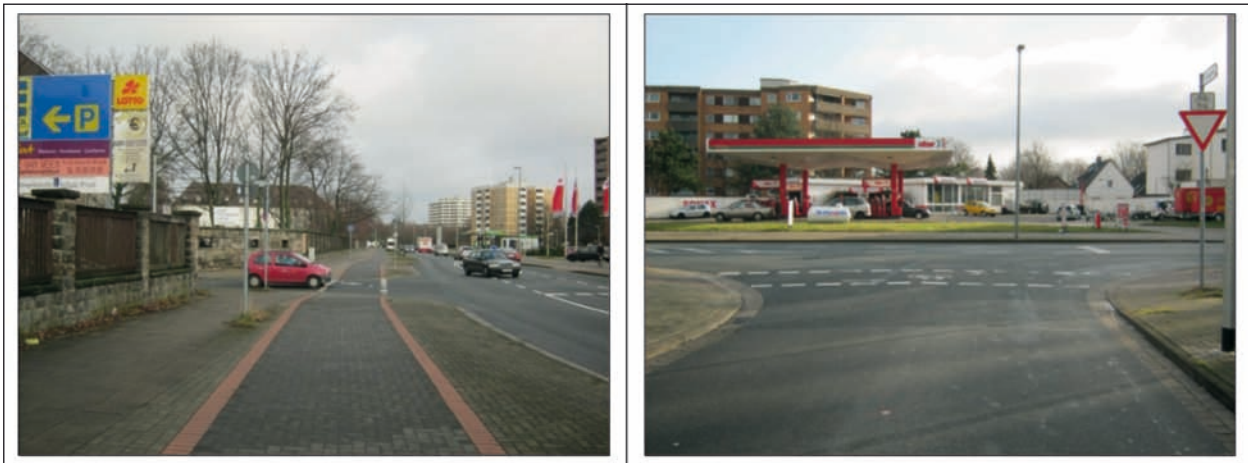
Bild 7-24: Sicherung gemäß VwV-StVO und zusätzliche Markierungen, aber eingeschränkte Annäherungssicht
