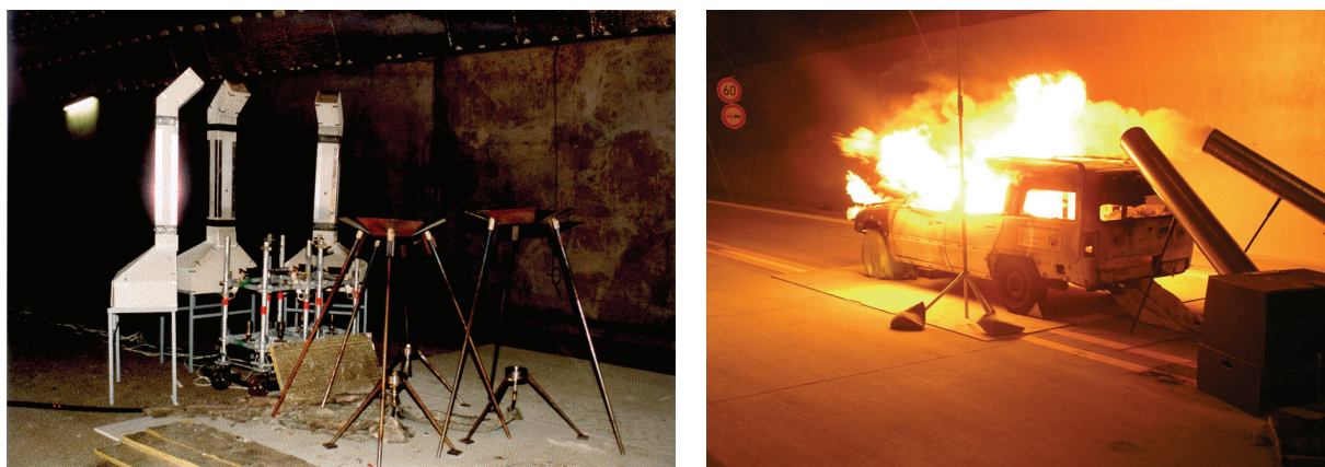
Abbildung 3-1: Brandversuche mit Gasbrennern in 4. Röhre Elbtunnel (links) und Tunnel Schwarzer Berg (rechts)
