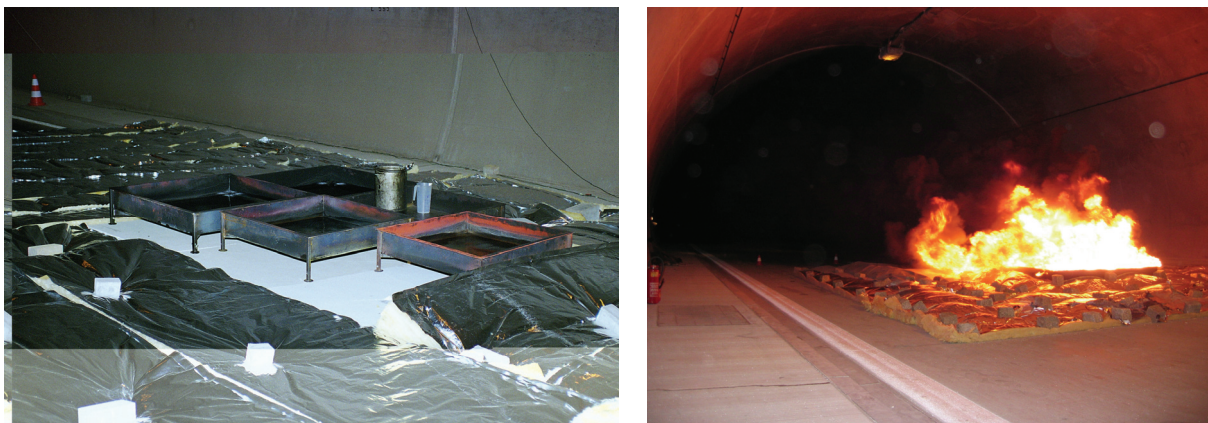
Abbildung 3-2: Brandversuche mit Stahlwannen im Rennsteigtunnel (links) und Tunnel Dölschen (rechts)
