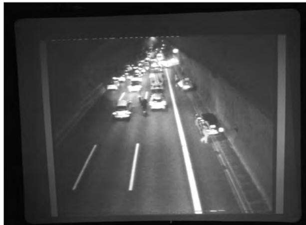
**Bild 4/24:** Simulation von Notfällen anhand Videoprojektion Anhand aufgezeichneter (echter) Ereignisse in Straßentunneln (z. B. Personen auf der Fahrbahn, Stau, Brand) in Verbindung mit Reaktionstests BAST, Verkehrssicherheitstag 2008
