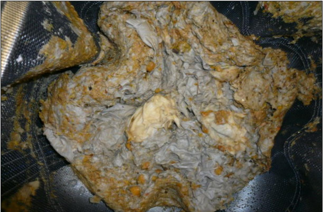
*Abbildung 7-3: Rückstände im Filtersack nach Entwässerung*
