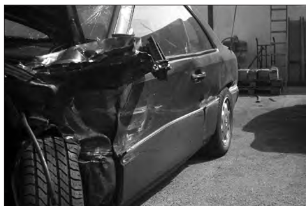
Bild 12: Eingeschlagenes und blockiertes Vorderrad und Streifschäden an der Fahrzeugseite
