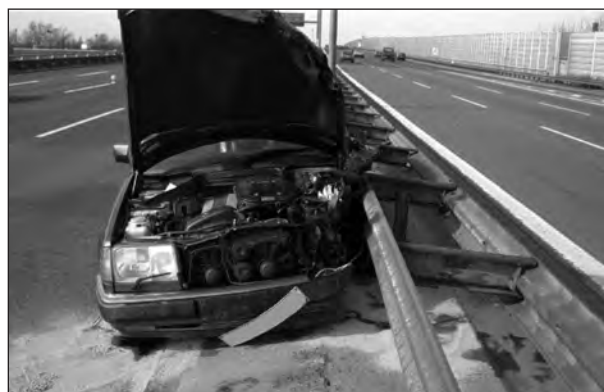
Bild 13: Endstellung des Mercedes an der Schutzplanke
