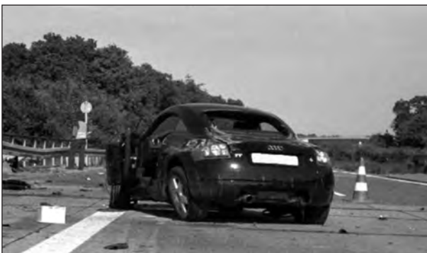
Bild 7: Beschädigte Hinterradaufhängung, hervorgerufen durch die zweite Kollision mit der EDSP nach Drehung
