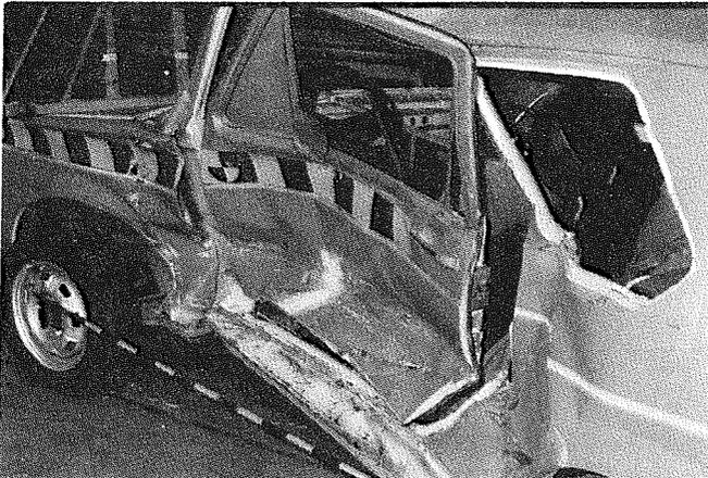
Bild 6: Seitliche Deformation des bewegten VW Golf nach dem Aufprall eines DB W 123
