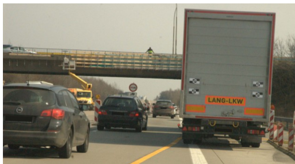
Bild 8: Fahrt eines Lang-Lkw durch eine Rückleitung
