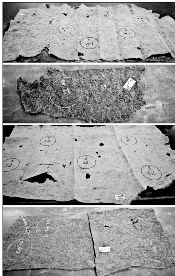
Bild 14: Probenentnahme zur Bestimmung der flächenbezogenen Masse an den geotextilen Schutzschichten (runde Prüfkörper)
